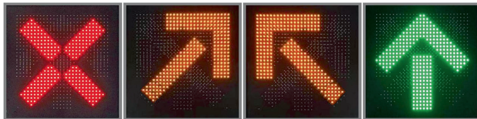
Рис. 5. Фазы реверсивного (магистрального) односекционного светофора. Представлена инновационная версия с разворотом на 180° и удлинненными желтыми стрелками, преобразованная в соответствии с излагаемой концепцией
